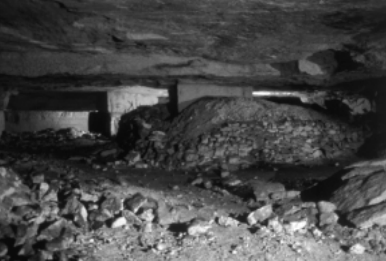
Abb. 6 : Grube mit Pfeilerbau. Der anfallende Schutt wurde hinter Trockenmauern gestapelt. Deckenhöhe ca. 2,5 Meter.
