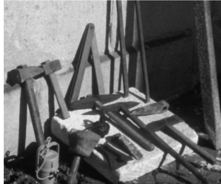
Abb. 15 : Werkzeuge der Ofenbauer, v.l.n.r.: 1. Reihe: Brecheisen, Scheideisen, Schmiege, Hämmer. 2. Reihe: Hebel, Flächt, Zweispitze, Keile, Frosch (Lampe), Scharriereisen, Klöppel, Karbidlampe. Bestand des Siebengebirgsmuseums Königswinter.
