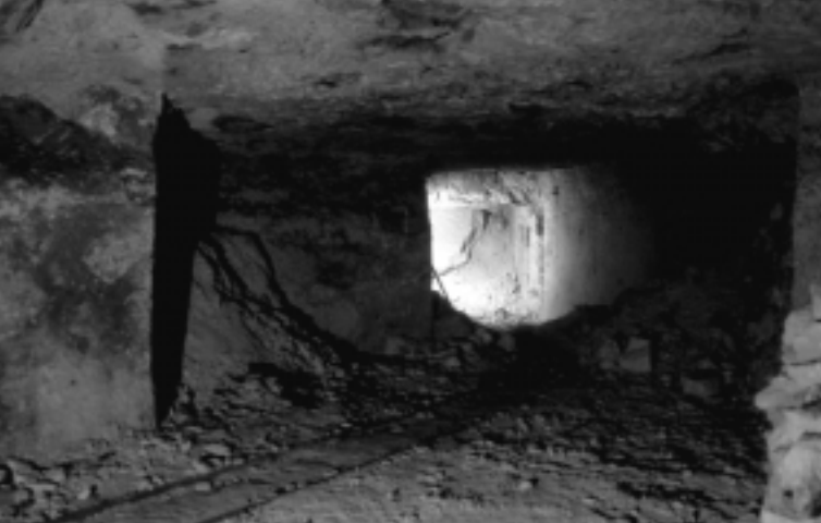
Abb. 13 : Feldbahngleise zum Steintransport innerhalb der Grube. Dazu wurden ein sogenannter "Hund" - ein flaches Rädergestell ohne Aufbau - benutzt.
