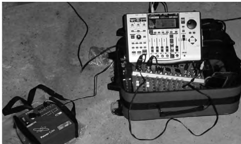
AFBEELDING 2: De gebruikte apparatuur. Links op de grond van links naar rechts: de versterker met luidspreker, minidisk speler, extra luidsprekertje. Op het statief de dB-meter SE322 en de microfoon Behringer B2-pro. Rechts in de tas van links naar rechts: de voedingsbron, het mengpaneel met de voeding voor de microfoons, de digitale recorder BR-864 van Boss; verder is nog net de DCC-recorder van Philips te zien.
