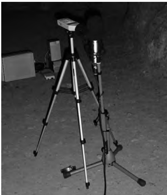
AFBEELDING 2: De gebruikte apparatuur. Links op de grond van links naar rechts: de versterker met luidspreker, minidisk speler, extra luidsprekertje. Op het statief de dB-meter SE322 en de microfoon Behringer B2-pro. Rechts in de tas van links naar rechts: de voedingsbron, het mengpaneel met de voeding voor de microfoons, de digitale recorder BR-864 van Boss; verder is nog net de DCC-recorder van Philips te zien.
