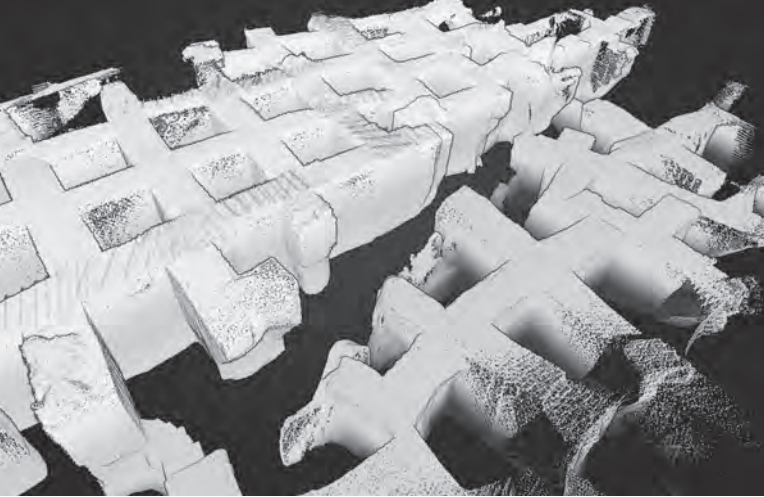
AFBEELDING 13: 3D beeld van een deel van de groeve Caestert met het hoger gelegen "Kapel gedeelte" dat verbonden is met enkele kleine doorgangen met de rest van de groeve, lager gelegen door de aanwezigheid van een breuk met verzet. De breuk wordt zichtbaar gemaakt doordat er stukken mergel uitgekapt zijn op het einde van de gangen in het lager gelegen gebied.
